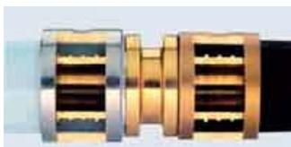
**PRINETO** - это высококачественная и многократно запатентованная система труб для питьевой воды, отопления и устройства тёплых полов. Гибкие трубы PE-X и стабильные трубы (PE-X-AL-PE-X) диаметром от 16 до 50мм соединяются при помощи, миллионы раз зарекомендовавшей себя, техники соединения запрессовочными гильзами. Вязкоэластичные свойства материала труб при этом используются для герметизации.
